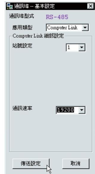
右側PLC選擇應用類型為 Computer Link。且通訊速率必須與左側PLC所選擇相同。
