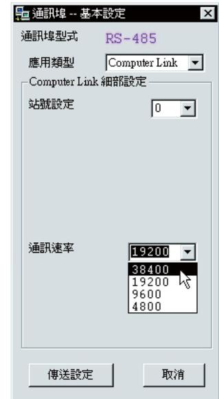
設定通訊速率，每台PLC及Ladder Master的通訊速率都必須一致。
