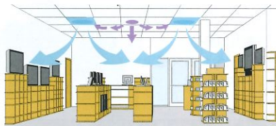
■ 空調出風口 ■ 輕鋼架節能循環扇
