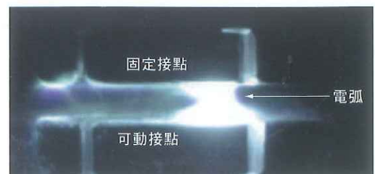
圖4 真空消弧管內部電弧行為觀察
