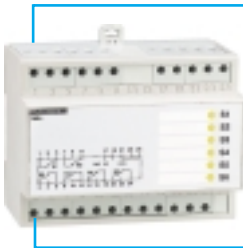
M6C 可程式接點 斷路器外部安裝的繼電器，只 有 6 個獨立的轉換接點，通過 3 根線與斷路器連接
