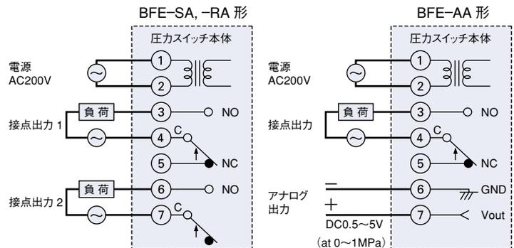
リレー接点は電源 OFF 状態を示します。
