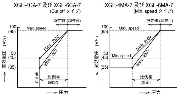
\*作動特性は使用する電圧および周波数(50/60Hz)、ファンモータの特性によって変動します。
