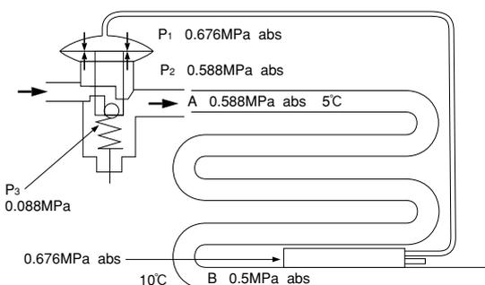
感温筒内部の圧力 (P<sub>1</sub>)
