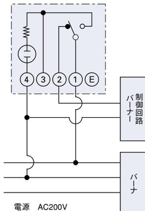
操作回路への電源を遮断することにより燃焼を停止させる方式
