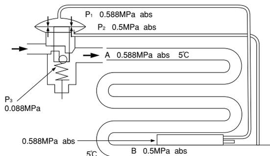
感温筒内部の圧力 (P<sub>1</sub>)
