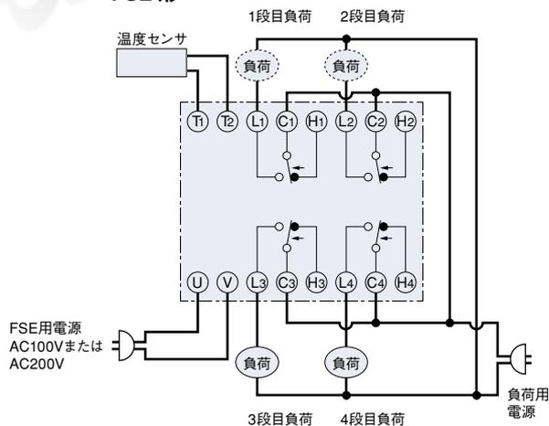
(冷房運転時) 温度上昇で矢印方向へ作動
