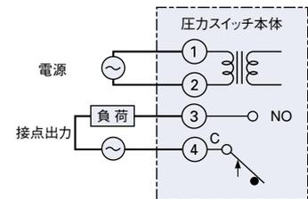
リレー接点は電源 OFF 状態を示します。
