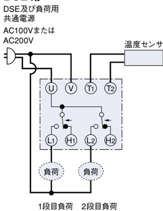
(冷房運転時) 温度上昇で矢印方向へ作動
