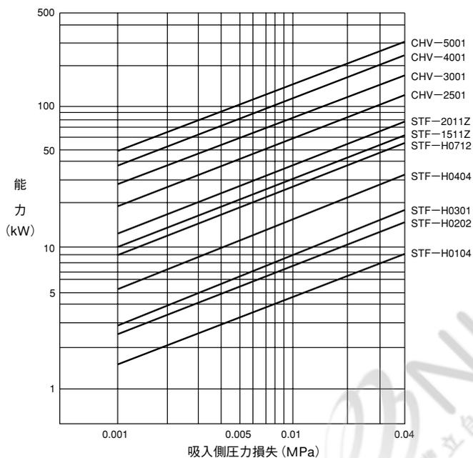
冷媒 R410A、凝縮温度 38℃、蒸発温度 5℃、過熱度 5℃
