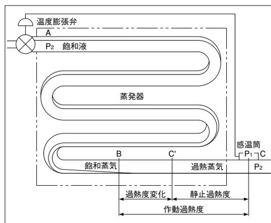
静止過熱度 (SSH): 弁が閉止から開き始めるまでの過熱度
