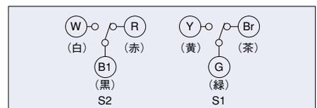
設定ダイヤルの矢印が下側のときの補助スイッチの接点状態
