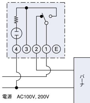
操作回路への電源を遮断する場合
