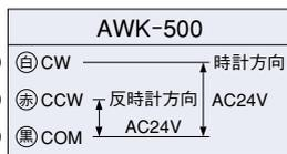
(例) AWK-500 シリーズは、「黒-白」間に AC24V を加えると、モータは時計方向 (CW) に回転します。また、「黒-赤」間に AC24V を加えると、モータは反時計方向 (CCW) に回転します。
