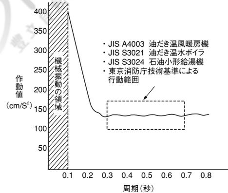
機械振動 0.1 秒(10Hz) 以下の場合は 350~400cm/s<sup>2</sup> 以上で作動し、地震特有の周期(0.3~0.7 秒)では 101~170cm/s<sup>2</sup> の範囲内で確実に作動します。
