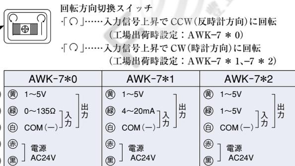
(例) AWK-7 \* 0 の場合「赤-黒」間に電源 (AC24V) を加え、「白-緑」間の入力信号 (0 ~ 135Ω) 上昇で、モータは反時計方向 (CCW) に回転します。(工場出荷時設定) 回転方向は、回転方向切換スイッチの設定により変えられます。
