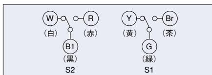
設定ダイヤルの矢印が上側のときの補助スイッチの接点状態
