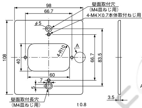
A部 電線引出し穴形状 (ARS-AE02のみ)
