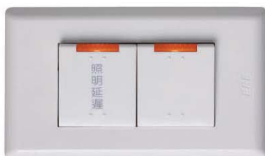
■ ET-5271 單開關單照明延遲開關 開關：15A / 110V / AC 用 延遲：單切、110V / AC 用 鎢絲燈 300W 日光燈 160W 用
