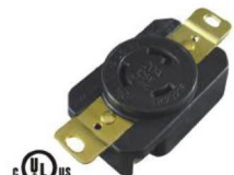
LK-2321F 美規引掛式暗插座 L5-20R 20A125V (2P3W)
