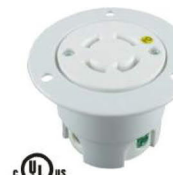
UL US ] LK-7431FO 美規引掛插入型母座 L14-30R 30A125/250V (3P4W)
