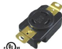
LK-2332F 美規引掛式暗插座 L6-30R 30A250V (2P3W)
