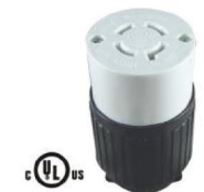
UL US ] LK-7421 美規引掛式中間插座 L14-20R 20A125/250V (3P4W)
