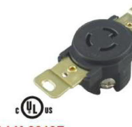
UL US LK-2313F 美規引掛式暗插座 L7-15R 15A277V (2P3W)
