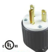
UL US LK7615P (10入/盒) 美規直式插頭 6-15P 15A250V (2P3W)
