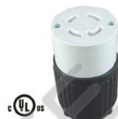
UL US ] LK-7431 美規引掛式中間插座 L14-30R 30A125/250V (3P4W)
