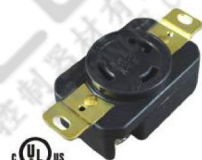
LK-2331F 美規引掛式暗插座 L5-30R 30A125V (2P3W)
