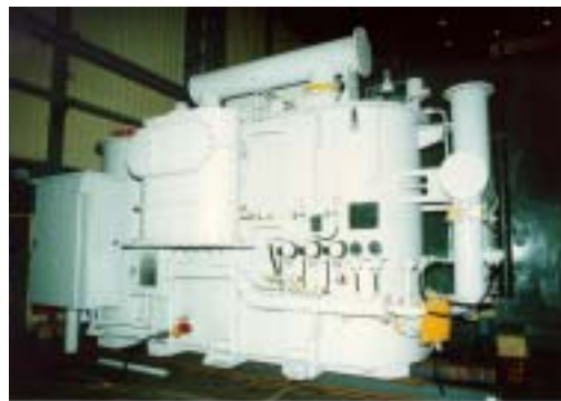
台電公司SF6氣體絕緣變壓器 69kV-25MVA
