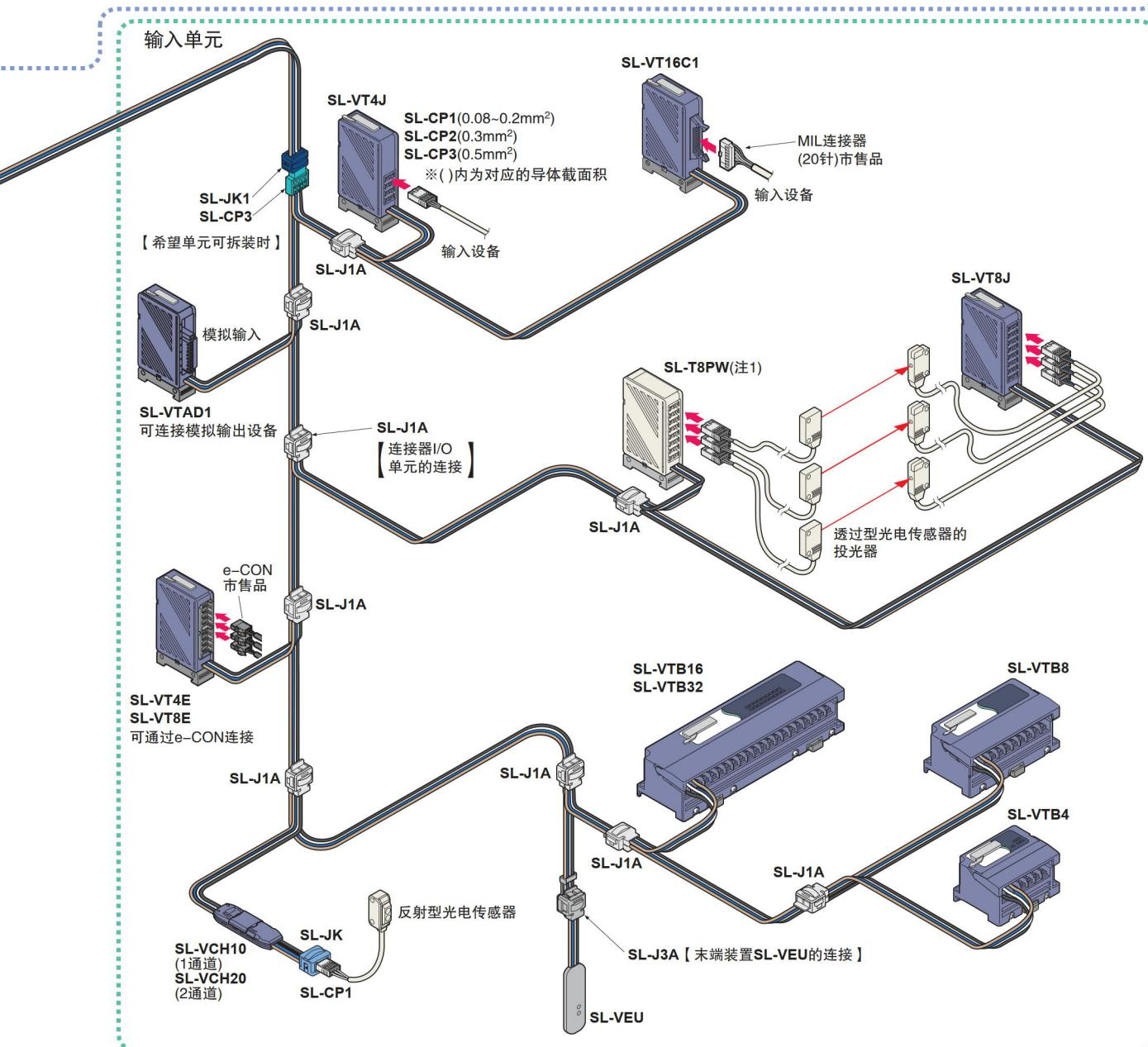
(注1): 可通过专用4芯扁平电缆供给 +24V~0V的DC电源，因此，可轻松连接透过型传感器的投光器，节省施工。
