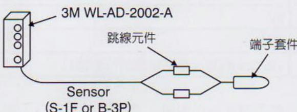
若要稠密地測到漏水且易循線檢視漏水點，建議每一檢知器搭配密集且短距離(例如不超過 150m )的檢知帶佈線方式。
