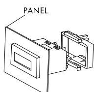
將計數器由面板的前面開孔置入，再從後面將護弓推入使計數器與開孔面板密合
