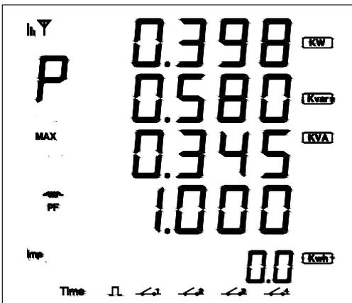
第 5 屏：需量、頻率最大值。系統有功功率需量，無功功率需量，視在功率需量，頻率最大值。如圖示：
