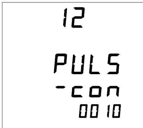
第 13 屏：繼電器 1 工作方式設定頁。CPM提供兩路繼電器輸出，具有“電平”和“脈衝”兩種輸出方式可供選擇。“0”表示“電平方式”，“1”表示“脈衝方式”。如圖示：設定繼電器 1 為脈衝方式。
