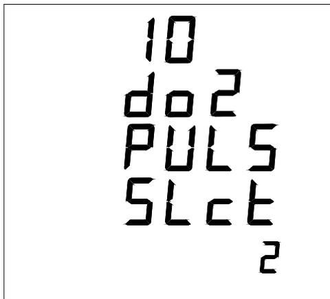
第 11 屏：脈衝輸出寬度設定頁。為 1~50 內的整數，單位寬度 20 毫秒，如圖示：設定脈衝高電平寬度為 2，即脈衝寬度為  $2 \times 20 = 40\text{ms}$ 。
