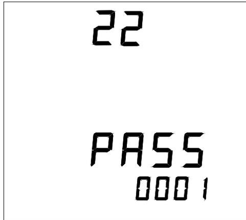
自此已完成了全部的參數設定，同時按下“H”鍵和“V/A”，退出設定模式進入測量參數顯示模式。
