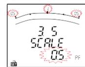
⑥ 電能測量 — ⑥ 設置要顯示的電能和無功電能的輸入/輸出、滯後/超前組合, 以及無功電能的測量方法。(僅限 ME96SSH-MB、ME96SSR-MB)
