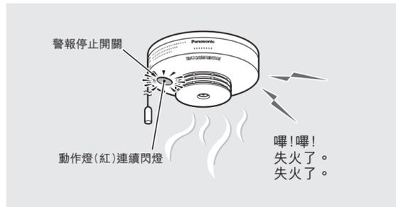
溫度降低後，火災警報動作即停止，回復到平常的狀態。
