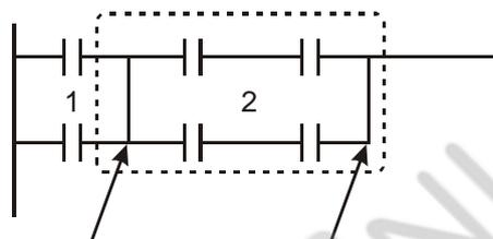
區塊 1 的合併線 區塊 2 的合併線
