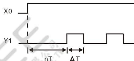
上圖的階梯圖程式使用計時器 T0 控制線圈 Y1 的受電時間，Y1 受電後，它在下個掃描周期又使計時器 T0 關閉，進而使 Y1 的輸出成了上圖中的振盪波形。其中 n 為計時器的十進制設定值，T 為該計時器時基（時鐘周期）。
