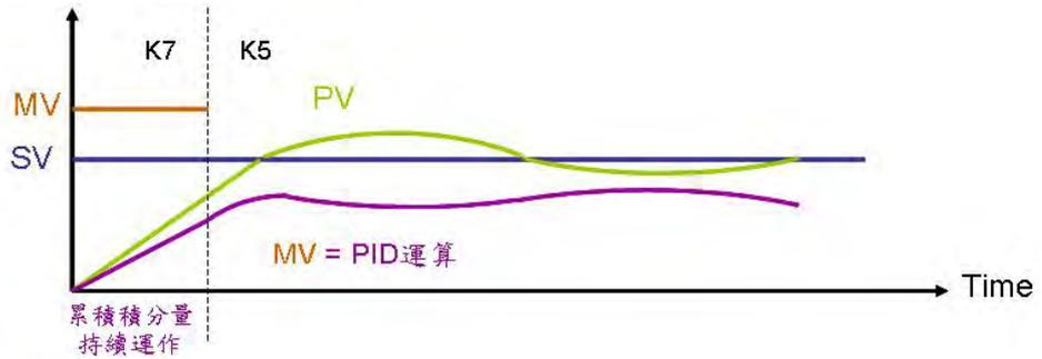
當手動模式(K7)切換至自動模式 K5 時，MV 輸出值將由使用者設定的輸出值，切換成 PID 運算的輸出值。
