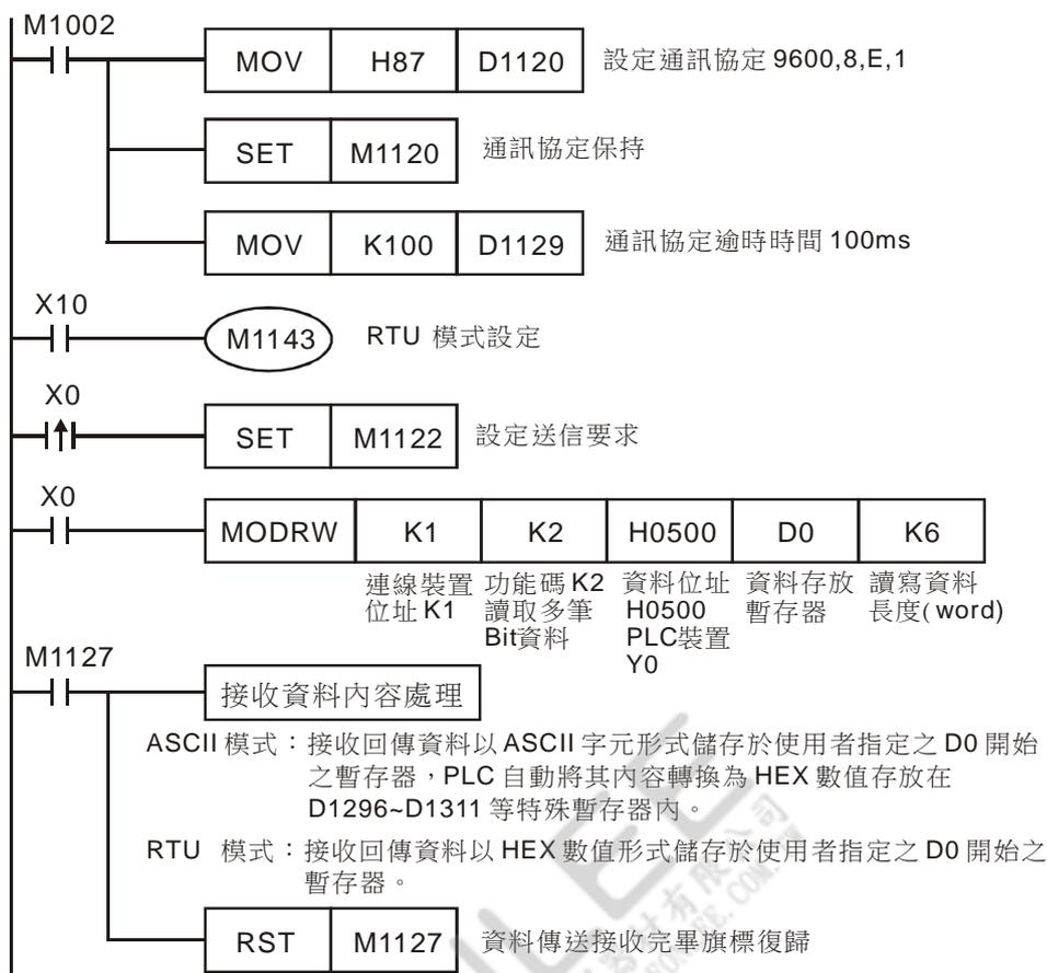
◆ ASCII Mode : PLC1 與 PLC2 連線
