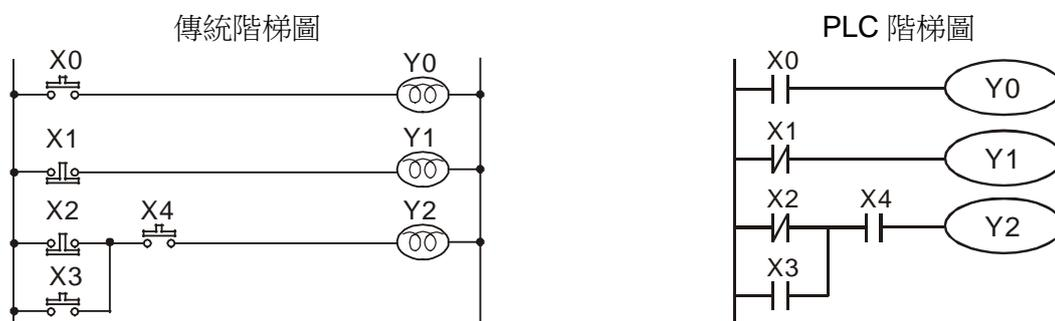
列 1：使用一常開開關 X0 (NO : Normally Open) 亦即一般所謂之“A”開關或接點。其特性是在平常（未壓下）時，其接點為開路（Off）狀態，故 Y0 不導通，而在開關動作（壓下按鈕）時，其接點變為導通（On），故 Y0 導通。
