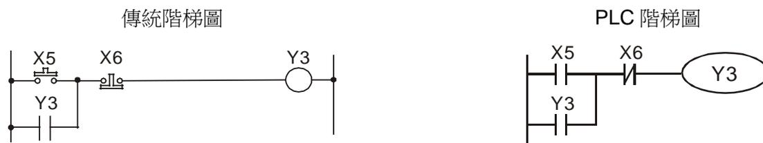
在此回路剛接上電源時，雖 X6 開關為 On，但 X5 開關為 Off，故 Y3 不動作。在啟動開關 X5 按下後，Y3 動作，一旦 Y3 動作後，即使放開啟動開關（X5 變成 Off）Y3 因為自身之接點回授而仍可繼續保持動作（此即為自我保持回路），其動作可以下表表示：
