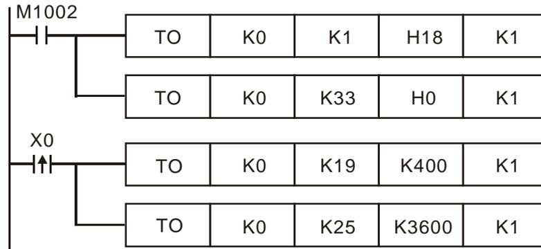
1. 對類比信號輸入模組編號 0 之 CR#1 寫入 H18, CH2 設為模式 3(電流輸入-20 mA ~ +20mA)。
