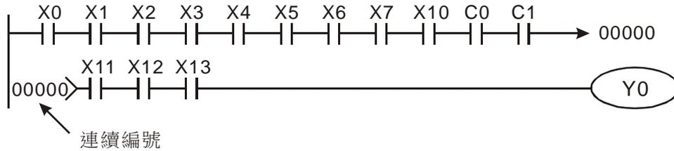
階梯圖程式的運作方式是由左上到右下的掃描。線圈及應用命令運算框等屬於輸出處理，在階梯圖形中置於最右邊。以下圖為例，我們來逐步分析階梯圖的流程順序，右上角的編號為其順序。
