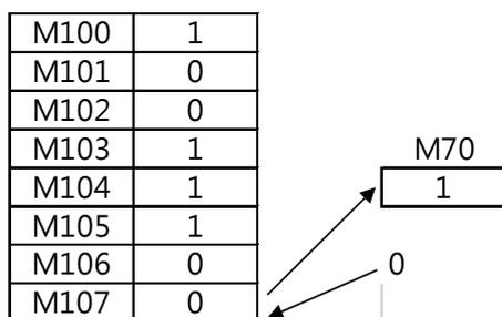
3. 執行 8 次 DTM 後的結果， $M70$  的狀態 1， $M100\sim107$  狀態皆為 0。
