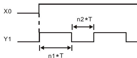
上圖是常用的使指示燈閃爍或使蜂鳴器報警用的振盪電路。它使用了兩個計時器，以控制 Y1 線圈的 On 及 Off 時間。其中  $n_1$ 、 $n_2$  分別為 T1 與 T2 的計時設定值，T 為該計時器時基（時鐘周期）。
