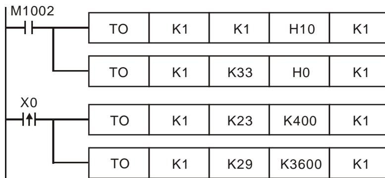
1. 對類比信號輸出模組編號 1 之 CR#1 寫入 H10，CH2 設為模式 2(電流輸出  $+4\text{mA}\sim+20\text{mA}$ )。
