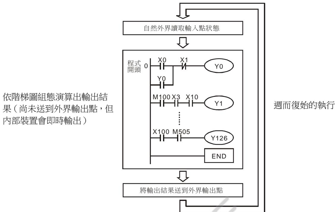
除上述掃描時間差異外，PLC 階梯圖和傳統階梯圖尚有“逆向回流”之差異，如下圖傳統階梯圖所示圖中，若 X0, X1, X4, X6 為導通，其它為不導通，在傳統之階梯圖回路上輸出 Y0 會如虛線所示形成迴路而為 On。但在 PLC 階梯圖中，因演算階梯圖程式係由上而下，由左而右地掃描。在同樣輸入條件下，以階梯圖編輯工具 (WPLSoft) 會檢查出階梯圖錯誤。
