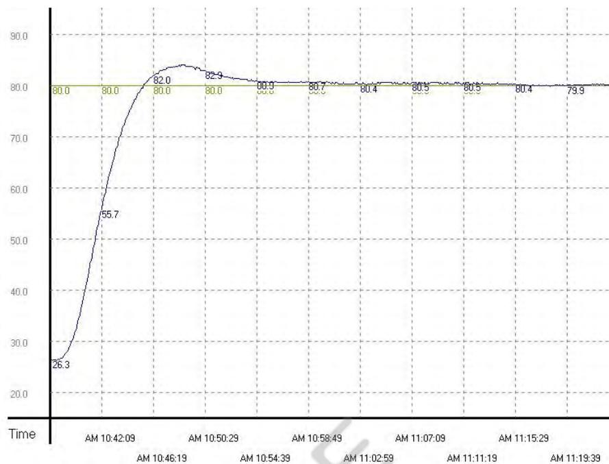
由上圖可看出經過自我調整後的溫度控制結果還不錯，而且控制時間大約只使用了 20 分鐘。接著驗證目標溫度由 80 度修改成 100 度，則得到的結果如下圖所示：
