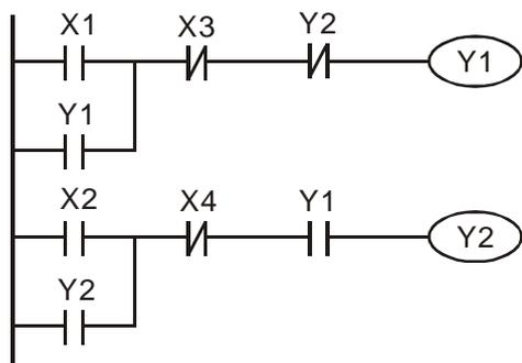
若把範例 5 “條件控制” 中 Y2 的常閉接點串入到 Y1 的電路中，作為 Y1 動作的一個 AND 條件(如左圖所示)，則這個電路不僅 Y1 作為 Y2 動作的條件，而且當 Y2 動作後還能停止 Y1 的動作，這樣就使 Y1 及 Y2 確實執行順序動作的程序。
