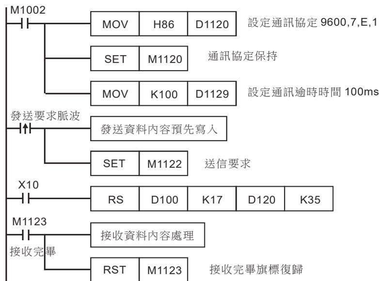
PLC ⇨ VFD-S，PLC 傳送：“：01 03 2101 0006 D4 CR LF ”
