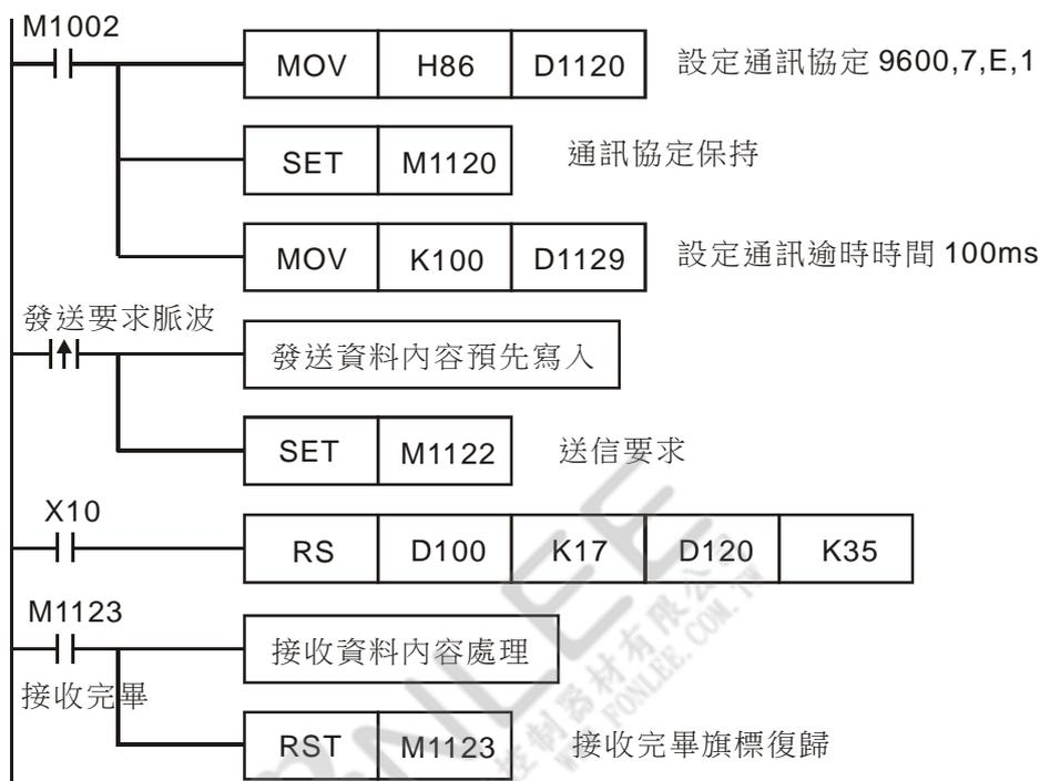
PLC ⇒ VFD-B , PLC 傳送 : “ : 01 03 2101 0006 D4 CR LF ”
