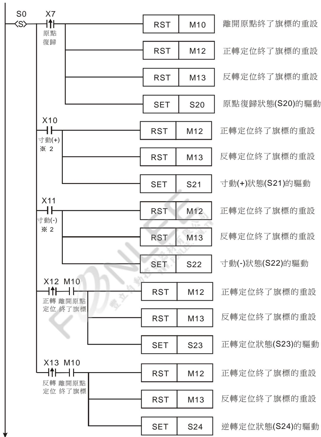
※2. 一次的寸動(JOG)運轉之最大移動量，等於 API 158 DDRVI 指令的輸出脈波數量之最大值  $-2,147,483,648 \sim +2,147,483,647$  的脈波個數。若是進行超出此數值的移動量，請再次執行寸動(JOG)動作。
