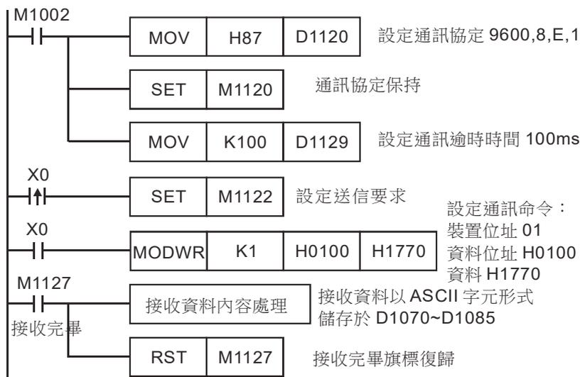
PLC ⇒ VFD-S, PLC 傳送：“01 06 0100 1770 71”
