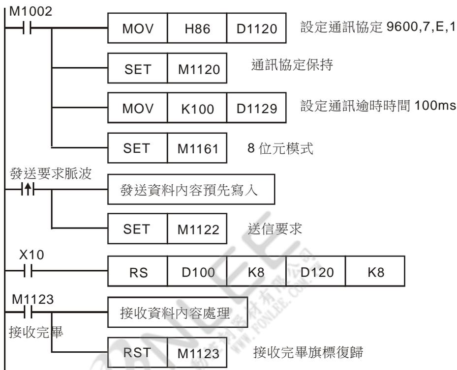
PLC ⇒ VFD-B, PLC 傳送: **01 06 2000 0012 02 07**
