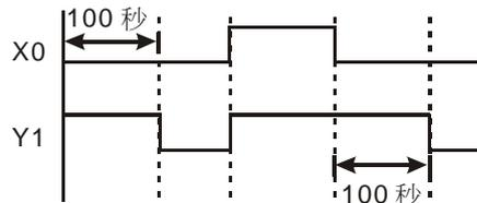
當輸入 X0 On 時，由於其對應常閉接點 Off，使計時器 T10 處於失電狀態，所以輸出線圈 Y1 受電，直到輸入 X0 Off 時，T10 得電並開始計時，輸出線圈 Y1 延時 100 秒（ $K1000 \times 0.1 \text{ 秒} = 100 \text{ 秒}$ ）後失電，請參考上圖的動作時序。
