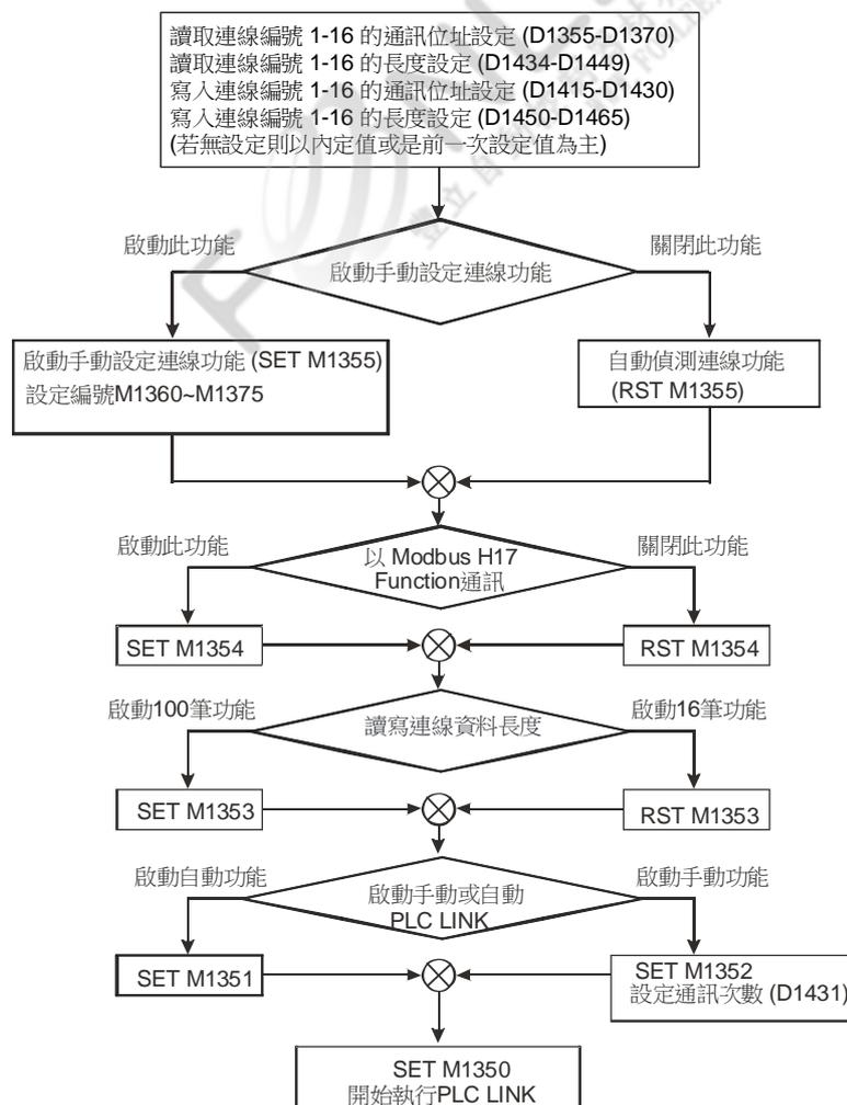
範例一：PLC LINK 搭配 M1353 啟動 PLC LINK 32 台及超過 16 筆讀寫功能基本用法
