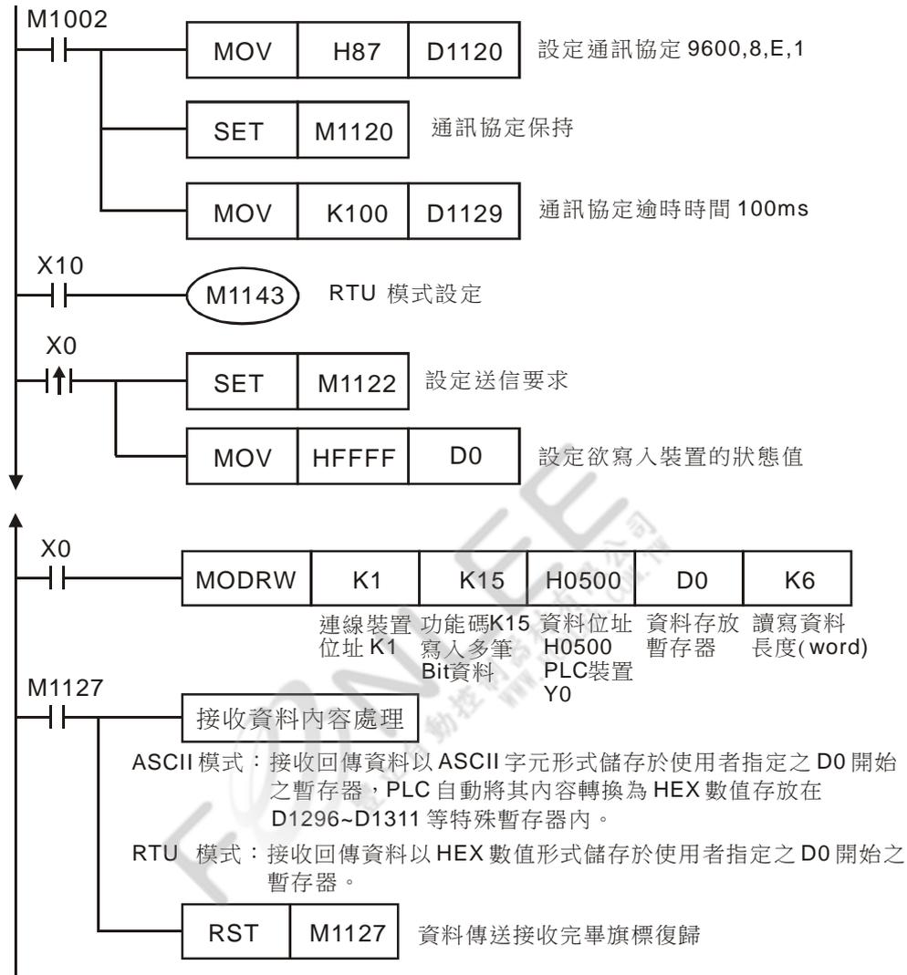
◆ ASCII Mode：PLC1 與 PLC2 連線
