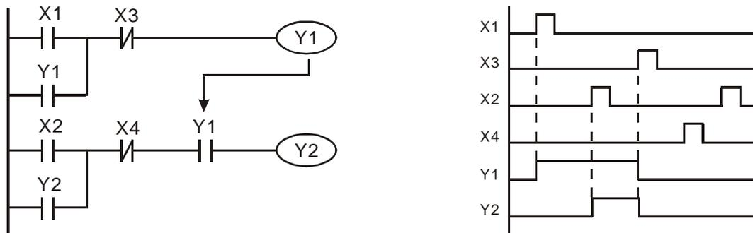
X1、X3 分別啟動/停止 Y1，X2、X4 分別啟動/停止 Y2，而且均有自保回路。由於 Y1 的常閉接點串聯了 Y2 的電路，成為 Y2 動作的一個 AND 的條件，所以 Y2 動作要以 Y1 動作為條件，Y1 動作中 Y2 才可能動作。
