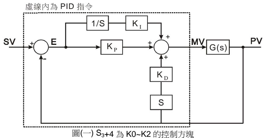
圖(一)中之  $S$  表示微分的動作，其動作定義為現在 PV 值減去前次 PV 值後，再除以取樣時間之動作；另外  $1/S$  表示積分的動作，其動作定義為前次積分值加上這次偏差量乘以取樣時間的值；最後圖中的  $G(S)$  表示受控裝置。
