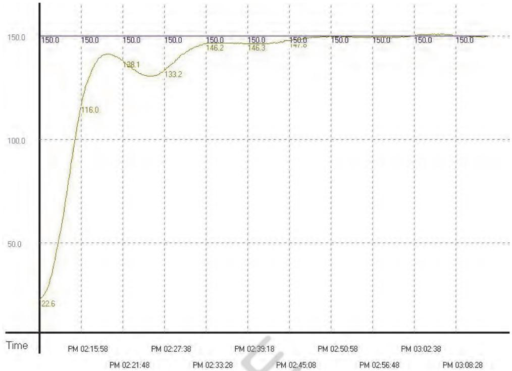
範例 4：為了實驗是否可更快加熱達到目標溫度的目的，因此修改範例三的取樣時間為 2 秒(即 D12=k20、D30=k2000)，經測試後實際結果記錄如下所示：
