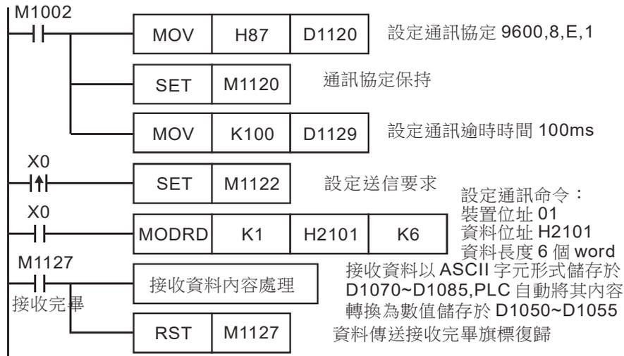
PLC ⇒ VFD-S，PLC 傳送：“01 03 2101 0006 D4”
