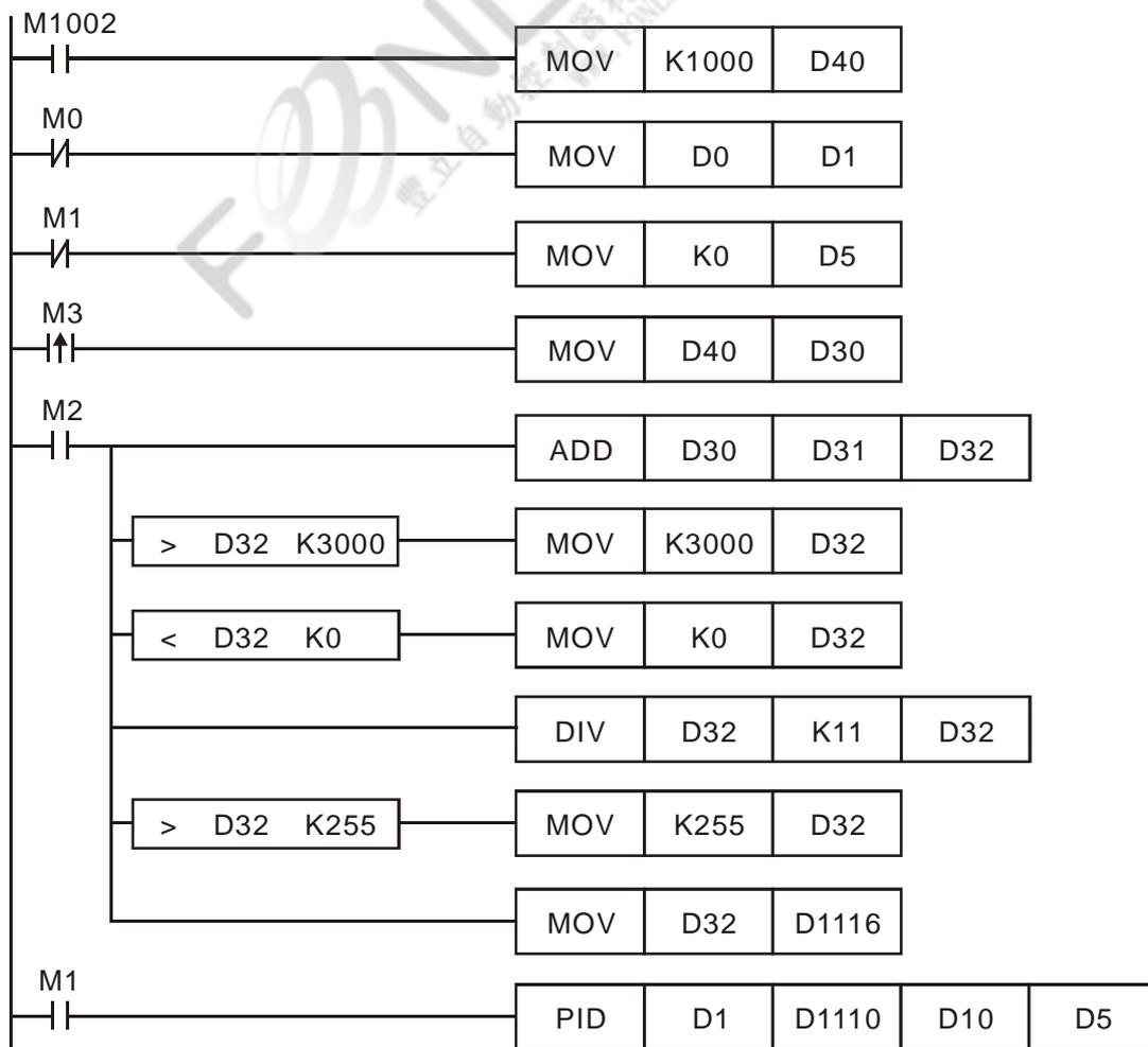
◆ 實例三：使用自動調整功能控制溫度。
