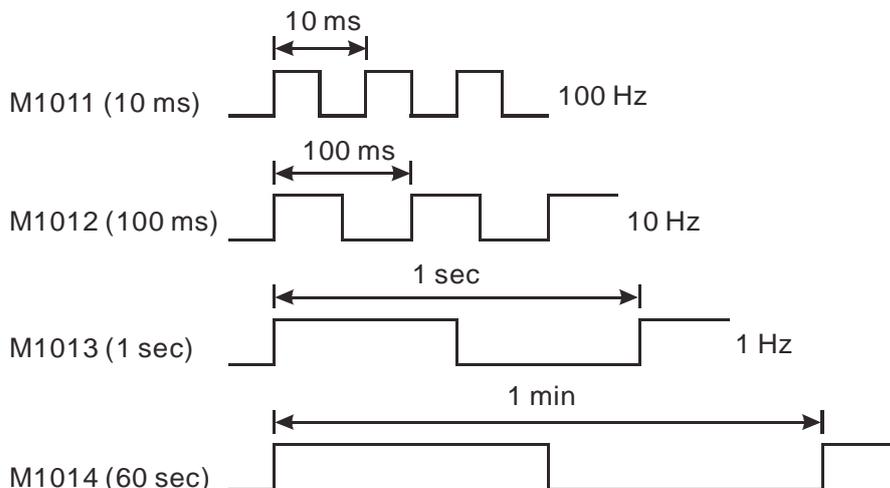
2. PLC 於 STOP 狀態下，時鐘脈波也會動作，時鐘脈波啟動時序與 RUN 的啟動時序並不會同步。
