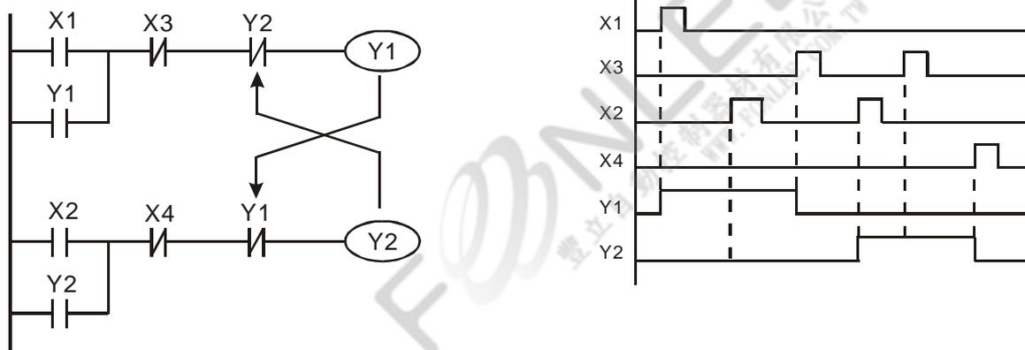
上圖為互鎖控制回路，啟動接點 X1、X2 那一個先有效，對應的輸出 Y1、Y2 將先動作，而且其中一個動作了，另一個就不會動作，也就是說 Y1、Y2 不會同時動作（互鎖作用）。即使 X1、X2 同時有效，由於階梯圖程式是自上而下掃描，Y1、Y2 也不可能同時動作。本階梯圖形只有讓 Y1 優先。
