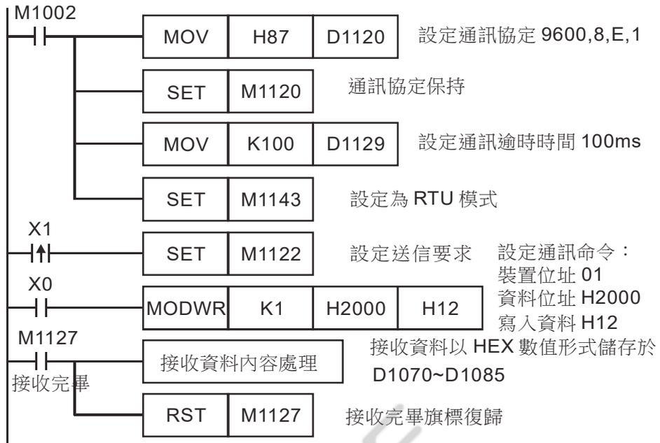
PLC ⇒ VFD-S, PLC 傳送： **01 06 2000 0012 02 07**
