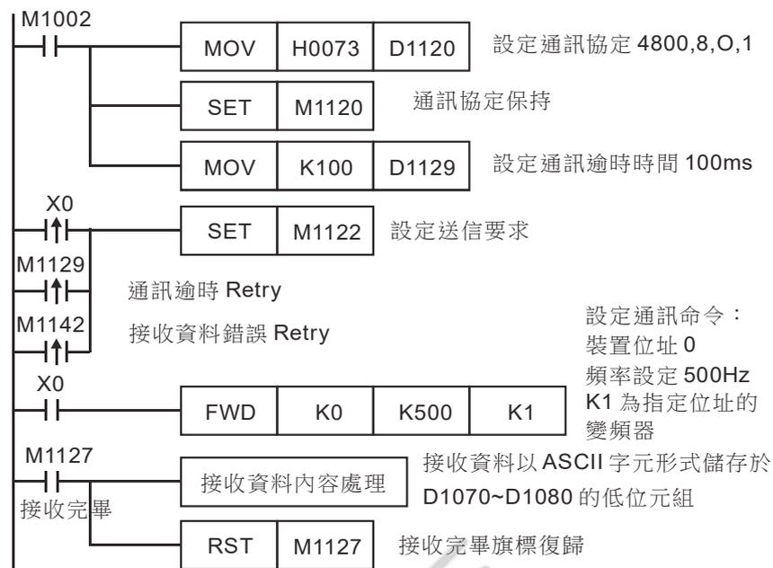
PLC ⇒ VFD-A，PLC 傳送：“C ♥ ☺ 0001 0500 ”
