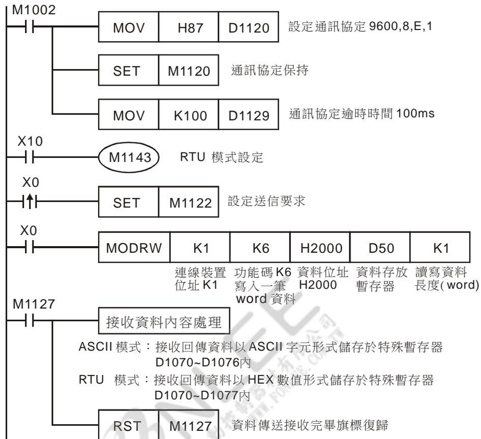
ASCII Mode：PLC 與 VFD-S 系列變頻器連線
