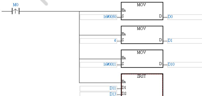
Step 4) LD M0 → 運用 CANRS 指令指定左側第一台模組 COPM-SL 傳送已設定傳送資料
