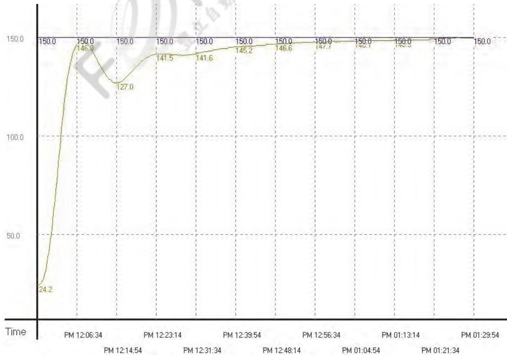
範例 3：為了將範例二達到更快加熱達到目標溫度的目的，因此修改取樣時間為 4 秒 (即  $D12=k40$ 、 $D30=k4000$ )，經測試後實際結果記錄如下所示：
