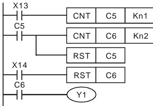
16 位元的計數器，計數範圍為 0~32,767，如左圖電路，用兩個計數器，可使計數數值擴大到  $n1*n2$ 。當計數器 C5 計數到達  $n1$  時，將使計數器 C6 計數一次，同時將自己復位(Reset)，以接著對來自 X13 的脈衝計數。當計數器 C6 計數到達  $n2$  時，則自 X13 輸入的脈衝正好是  $n1*n2$  次。
