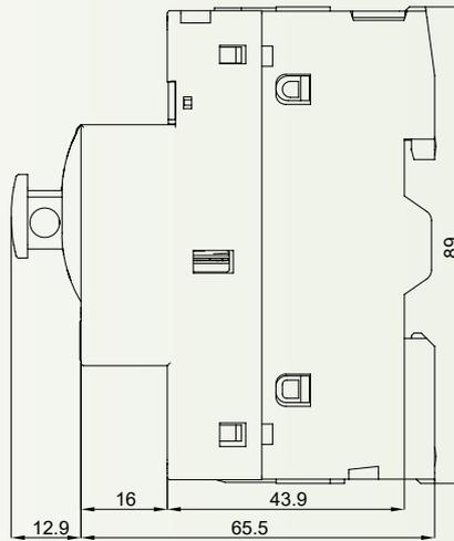
電動機保護斷路器
