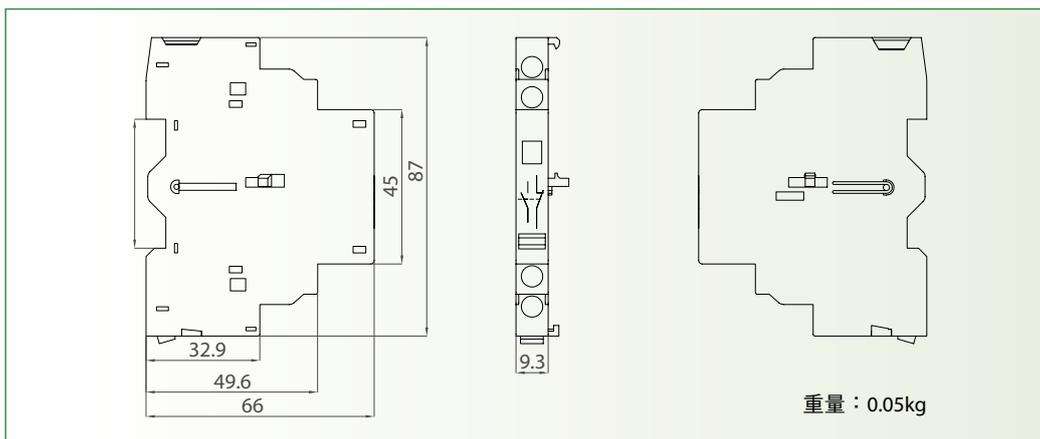
◆ 電壓/欠電壓跳脫裝置
