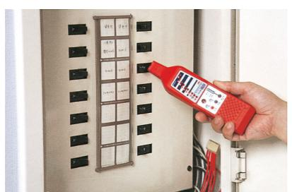
3. 找到開關箱，將追蹤器的開關推至「CKTBKR」的位置，打開開關箱，檢查每個熔絲或無熔絲開關。當追蹤器的發光二極體(LEDs)環達到最亮且聲音最響時，您要找的線路開關便是最接近追蹤器的那一個。
