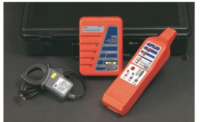
線路追蹤器可幫助您精確鎖定線路在牆內、天花板上或地板下的位置，也可利用它來找出某條線路相對的熔絲、斷路器，以幫助工程人員裝設與維修設備。
