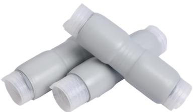
3M的冷縮密封組件 CNCST-2 提供一種安全簡易的方法，給予同軸電纜可靠的密封連接。它是用於無線通訊基站和其他裸露的同軸連接處的理想密封材料。每套3M冷縮密封組件都備有內置膠泥的冷縮矽橡膠管，該冷縮管是被預先擴張在一個可抽出的芯繩上，操作簡易，只需定位於安裝處，抽出芯繩即可。
