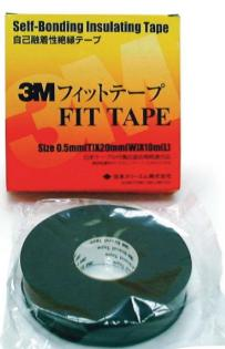
**FIT** 高壓絕緣膠帶使用於電纜接頭、匯流排絕緣、接續絕緣、電纜終端、中間接頭處理及架空絕緣線的防水密封用。此款產品符合日本JCAA D004標準，絕緣破壞強度為28kV/mm。
