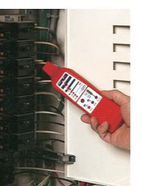
4. 確定所找到的熔絲或無熔絲開關是正確的，將追蹤器的開關推至「WIRE」的位置，然後以追蹤器的尖端沿著熔絲或無熔絲開關的線路追蹤，只有正確的線路才能使追蹤器閃爍。
