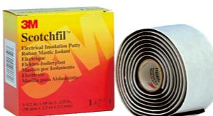
**Putty** 自融性絕緣填縫膠膏帶，是一款電氣級橡膠基材，具有彈性的膠膏帶，它能纏繞、拉伸或快速地成形於不規則的外形上作絕緣之用。其經過UL認證，可作為80°C以下電氣導體的接頭絕緣，纏繞後外部用Super 33+ , Super 88電氣絕緣膠帶作保護。
