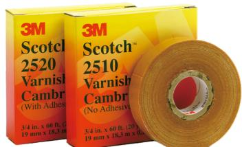
**2510** 絝緣麻帶是直切棉織麻紗材料製成。此材料是由油和高品質的黃色電氣絕緣清漆所構成。富有彈性、電氣絕緣與防潮功用。可在氣溫高達105°C時，以極佳的耐磨性、耐穿刺等特性順利完成工作。
