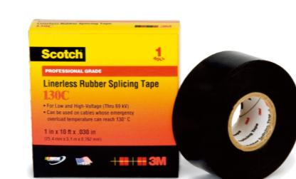
130C是適形性很好、含膠、無離形紙的乙炳橡膠帶基絕緣膠帶。可應用於90°C的持續工作溫度和130°C應急溫度，有助於接頭處的散熱。具有優異的物理和電氣性能，可以迅速填充空隙達到防潮密封的作用。適用於低壓絕緣，也可用於高達69,000V的電壓絕緣。
