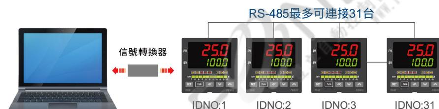
相容Modbus RTU通訊協議，可與市面上所有人機界面、PLC和SCADA軟體快速建立連結。
