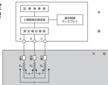
・測定極切替部及び2極間抵抗測定部により、A種-B種、B種-D種、D種-A種間の交流抵抗値を自動的に順次測定し、データを記憶演算部に送る。
