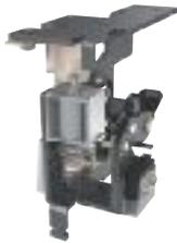
如果配置了ETR，則作為標準提供OCR警報(AL)。OCR警報為脈衝輸出(30毫秒)的接點(1a)，它在斷路器為電子式跳脫電驛跳脫後的電氣指示信號，可以使用自動復歸(標準)和手動復歸(可選)這兩種型號。
