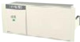
當線路中存在許多高諧波成分時，這些高諧波成分可能累加到中性極上。額定電流（100%）的中性極過電流保護功能（標準），得以保護因為高諧波而導致之中性極過電流得以跳脫保護，但如果只想保護額定電流（50%）的中性極過電流，那麼可透過N極50%保護模組（選配）來實現中性極的50%保護。
